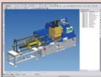
Abbrenn-Stumpfschweißmaschine GAA60 zum Schweißen von Lastwagenachsen bis 3m Länge
