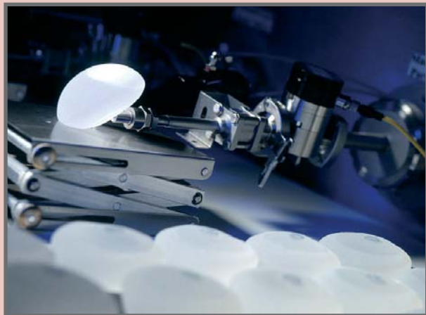
Die Hüllen werden mit Hilfe einer Injektionsnadel mit speziellem Silikongel gefüllt.
