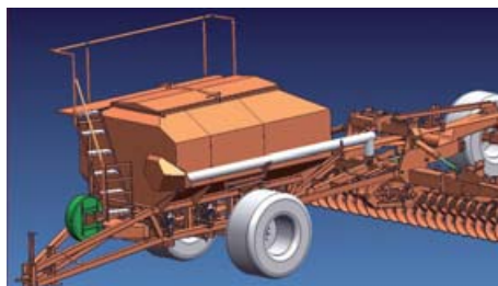
Ausschnitt einer schematischen Darstellung der Großsämaschine Jantar
