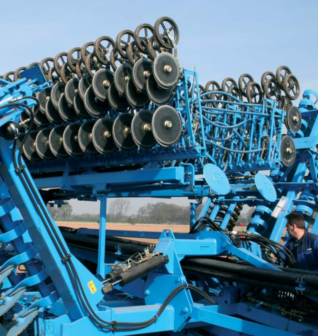
Klappvorgang einer 12 Meter breiten Säkombination von Arbeitsposition in Transportstellung
