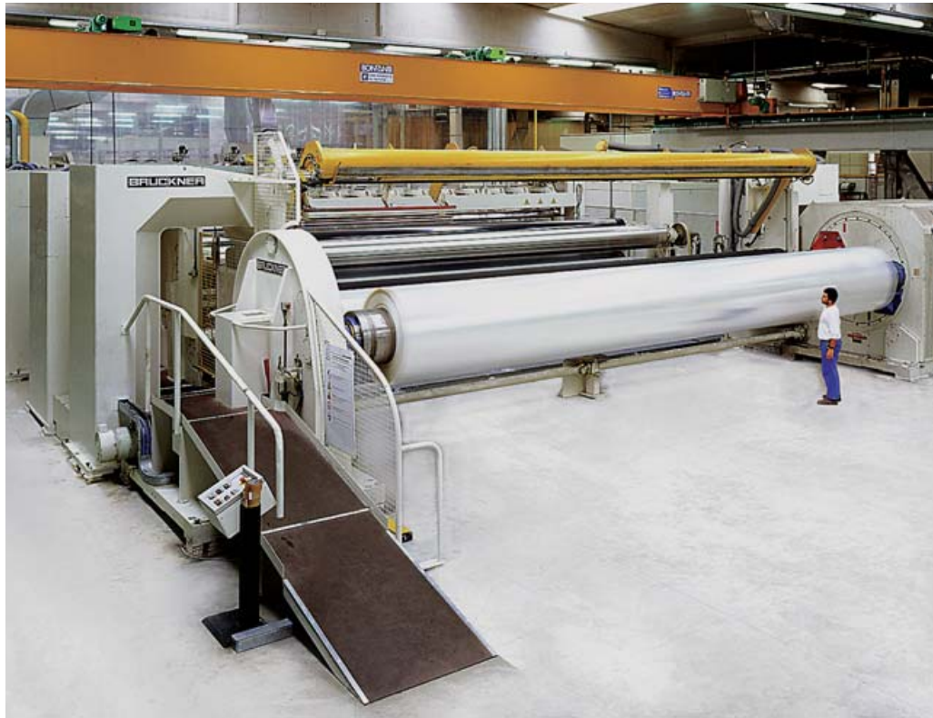
Der Pull Roll verbindet Einheiten zur Oberflächenbehandlung der Folie mit Messern zum Randabschnitt und Transportwalzen – auf dem Wickler wird das fertige Halbzeug gespeichert.
