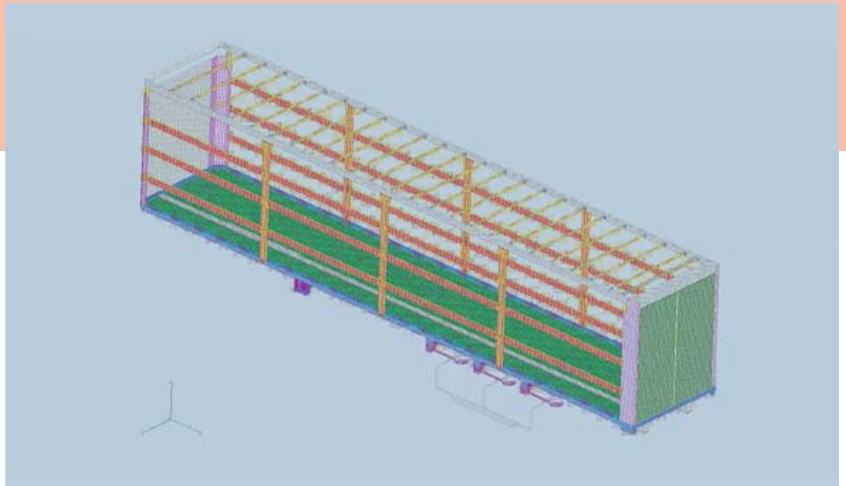
Modell eines Sattelaufhängers für die Eigenfrequenzanalyse
