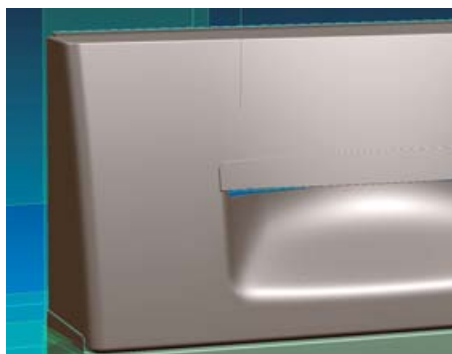
Mit dem hybriden Modellierer von NX kann man Flächen über Kurven definieren oder durch direkte Steuerung der Kontrollpunkte in die gewünschte Form bringen.
