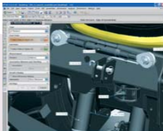
Bild 5: Trotz Facettenmodell können einzelne Komponenten der Baugruppe ausgewählt werden, einzelne Flächen oder auch Bohrmittelpunkte sind selektierbar, um beispielsweise Messungen durchzuführen.
