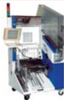
Abb. 2: MT9918 Gravity Handler (gleichzeitiger Test von bis zu 8 Bausteinen)
