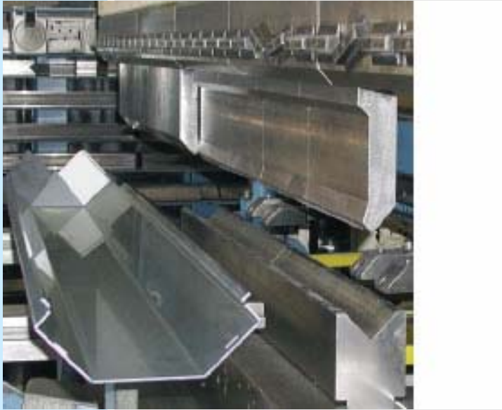
Das Bild zeigt: Abkanten einer Blechkonstruktion
