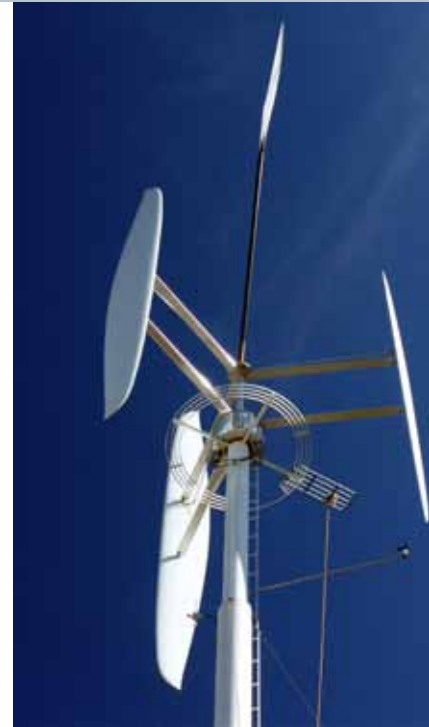
Innovative mechanische Komponenten entwickelte PSA für eine neuartige Kleinwindanlage mit senkrechten H-Rotoren.
