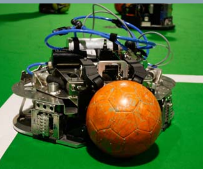
Die Ballführung als 3D-Modell in NX und als reale Baugruppe. Sie demonstriert den modularen Aufbau der Krikkit-3 Roboter.
