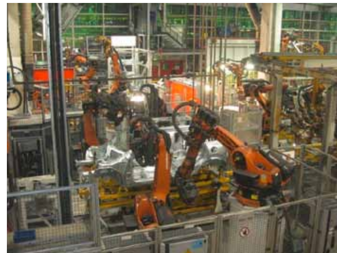
Etwa 180 Roboter umfasst die Rohbaulinie.
